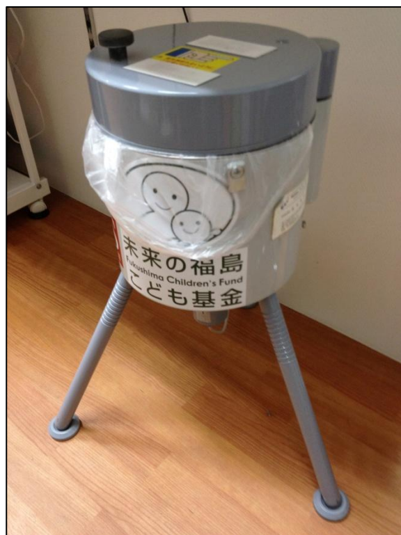
ATOMTEX AT1320A (2.5インチNaI(Tl)シンチレーション式)
