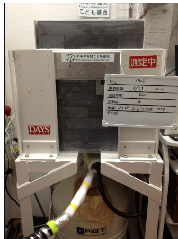
Princeton Gamma-Tech NIGC16190SD (ゲルマニウム半導体検出器、相対効率19.75%)
