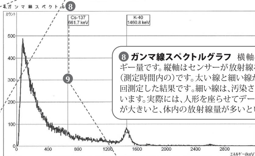
⑧ ガンマ線スペクトルグラフ 横軸はガンマ線の放出エネルギー量です。縦軸はセンサーが放射線を捕らえたカウント総数(測定時間内の)です。太い線と細い線がありますが、太い線は今回測定した結果です。細い線は、汚染されていない人を想定しています。実際には、人形を座らせてデータを取っています。この差が大きいと、体内的放射線量が多いということになります。
